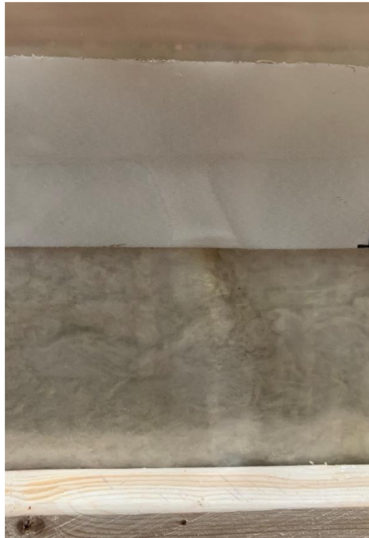
Figure 8 - Essai en laboratoire - Canal d'air au scellement de deux membranes polyéthylène sur une surface flexible, soit l'isolant en nattes de laine de roche
