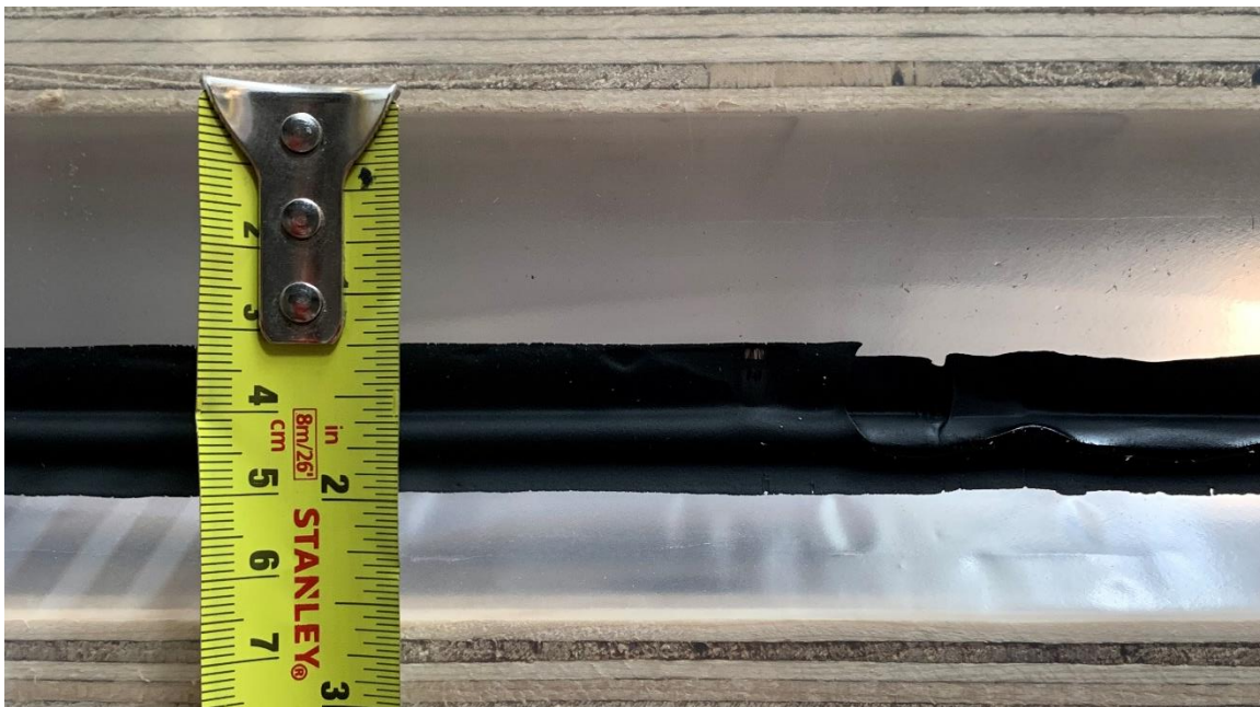
Figure 9 – Essai en laboratoire - Élongation du produit de butyle entre deux membranes polyéthylène pare-vapeur
