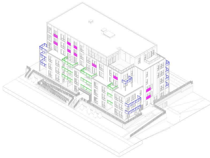
Figures 15 : Schéma des différents types de balcons. Juliettes en rose, balcons sur poteaux en bleu, et loggias en vert.
