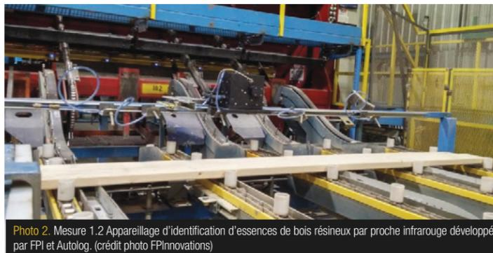
Photo 2. Mesure 1.2 Appareillage d'identification d'essences de bois résineux par proche infrarouge développé par FPI et Autolog. (crédit photo FPInnovations)
