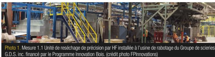
Photo 1. Mesure 1.1 Unité de reséchage de précision par HF installée à l'usine de rabotage du Groupe de scieries G.D.S. inc. financé par le Programme Innovation Bois. (crédit photo FPInnovations)
