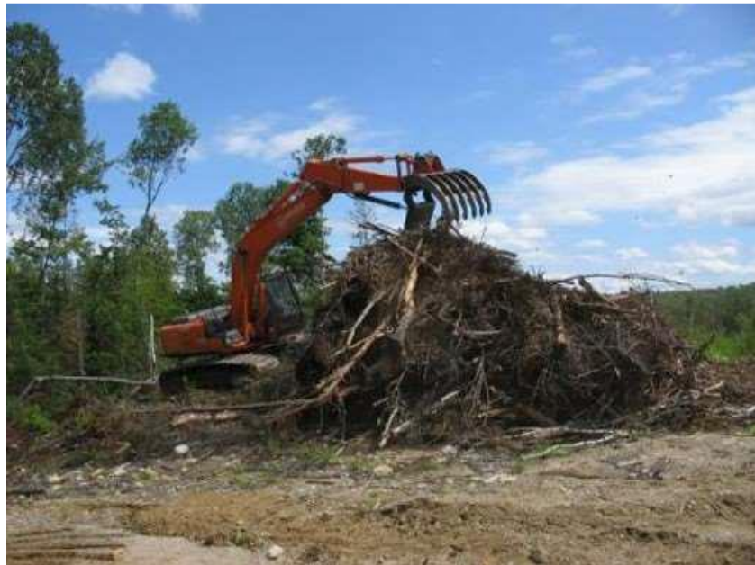
Figure 12 Chargeuse sur chenilles configurée pour la manutention de biomasse forestière (FPInnovations, 2022)
