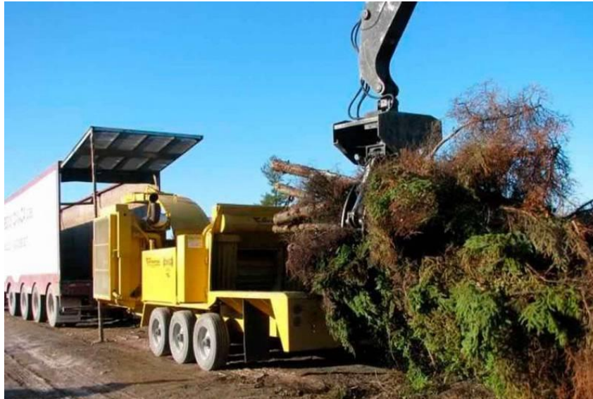
Figure 9 Broyage en forêt de biomasse et chargement dans un semi-remorque à plancher mobile pour expédition
