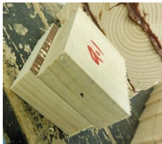
Figure 8. Dimensions et éprouvettes pour essais de cisaillement
