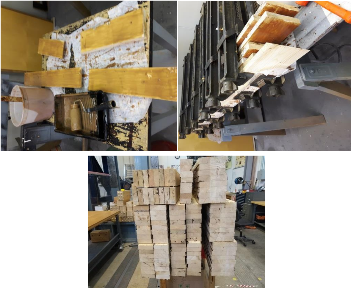
Figure 10. Processus d'encollage et serrage des BLCs
