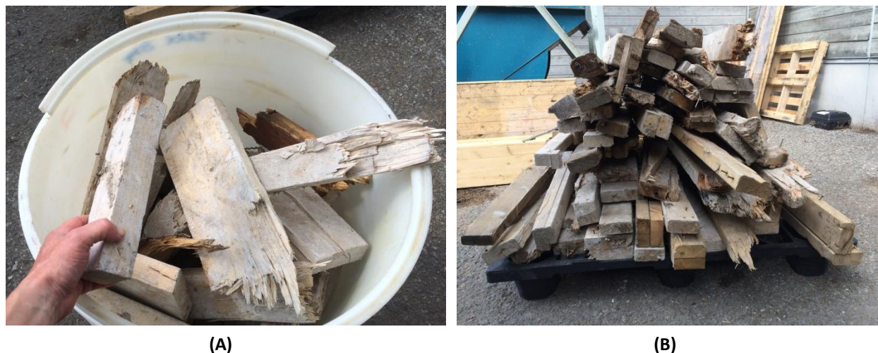
Figure 4. Planches exclues de l'étude : sous-dimensionnées (A) et présence abondante de clous et/ou vis (B)
