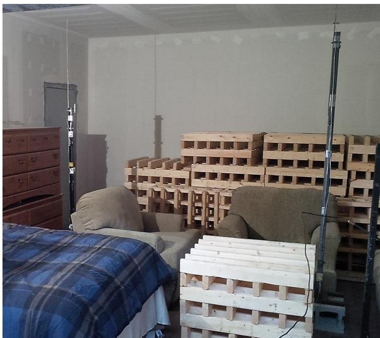
a) Colonnes de thermocouples à l'intérieur du compartiment d'origine
