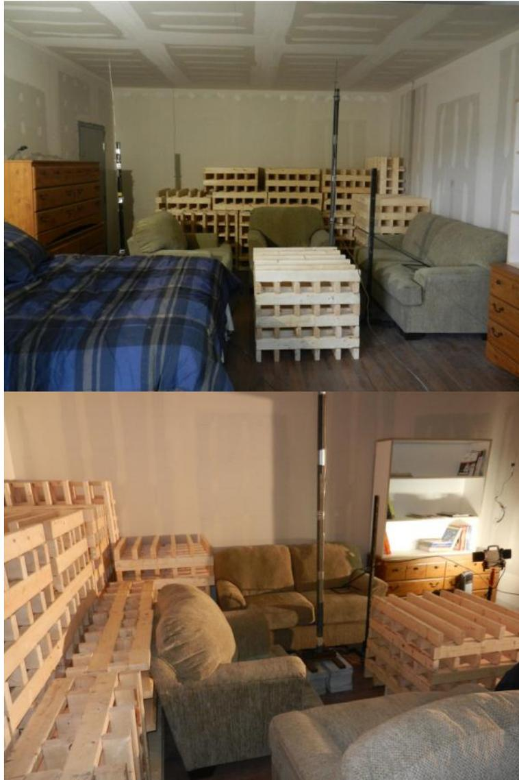
**Figure 12. Photographies de la disposition du combustible dans le compartiment résistant au feu**
