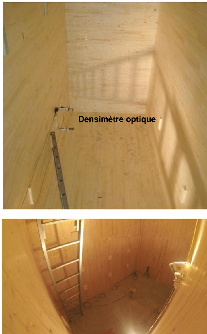
**Figure 13. Instrumentation à l'intérieur du puits d'escalier ou d'ascenseur**
