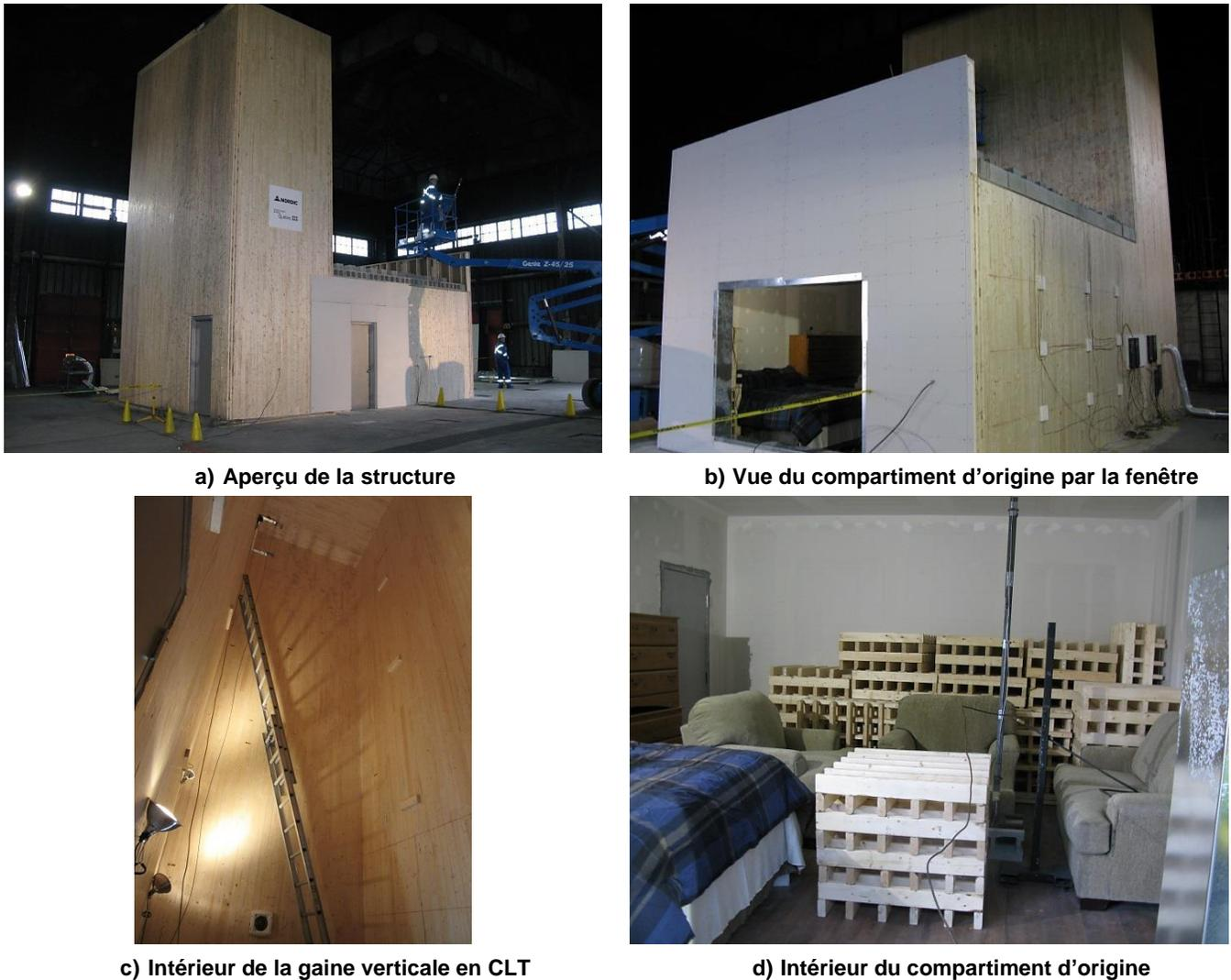
Figure 1. Photos de la structure en CLT
