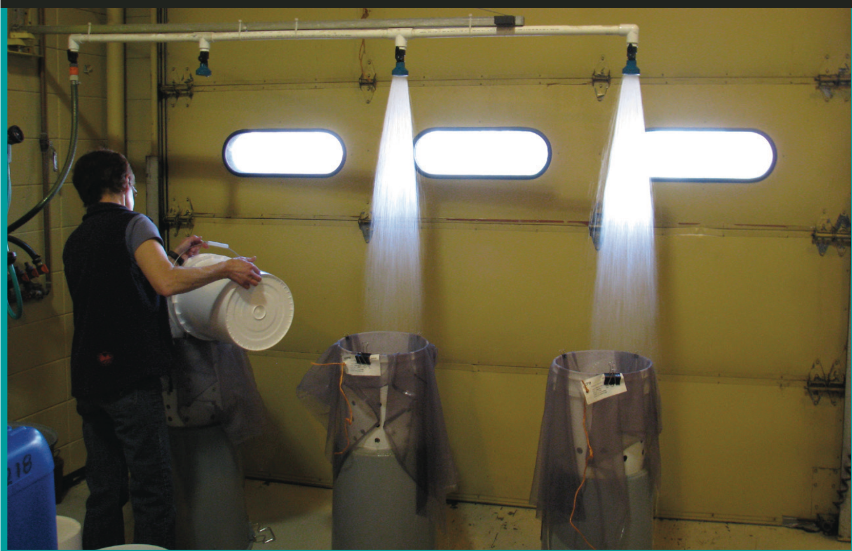
Rinçage après le traitement au peroxyde
