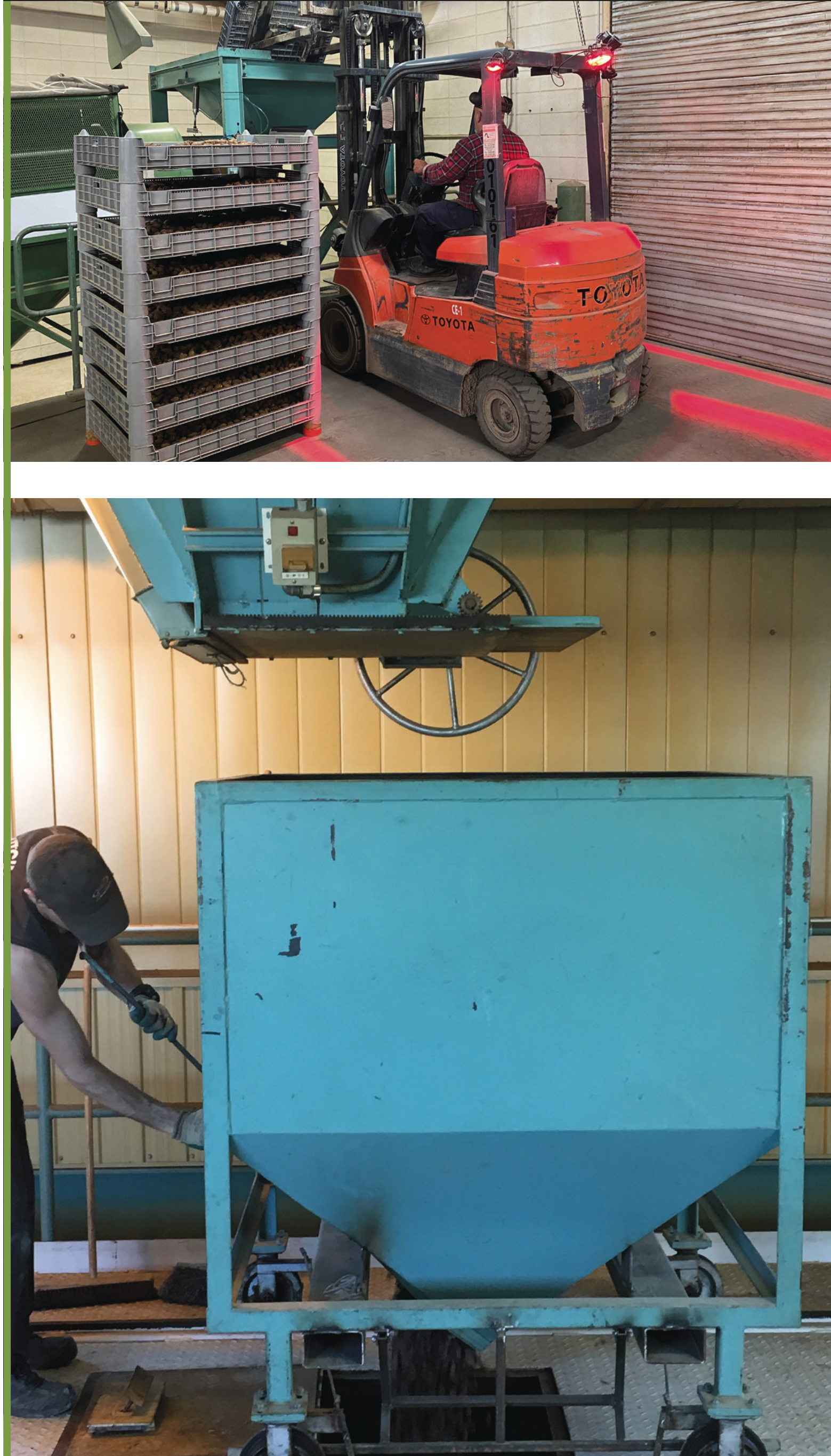
2. Transfert des cônes dans le tarare
