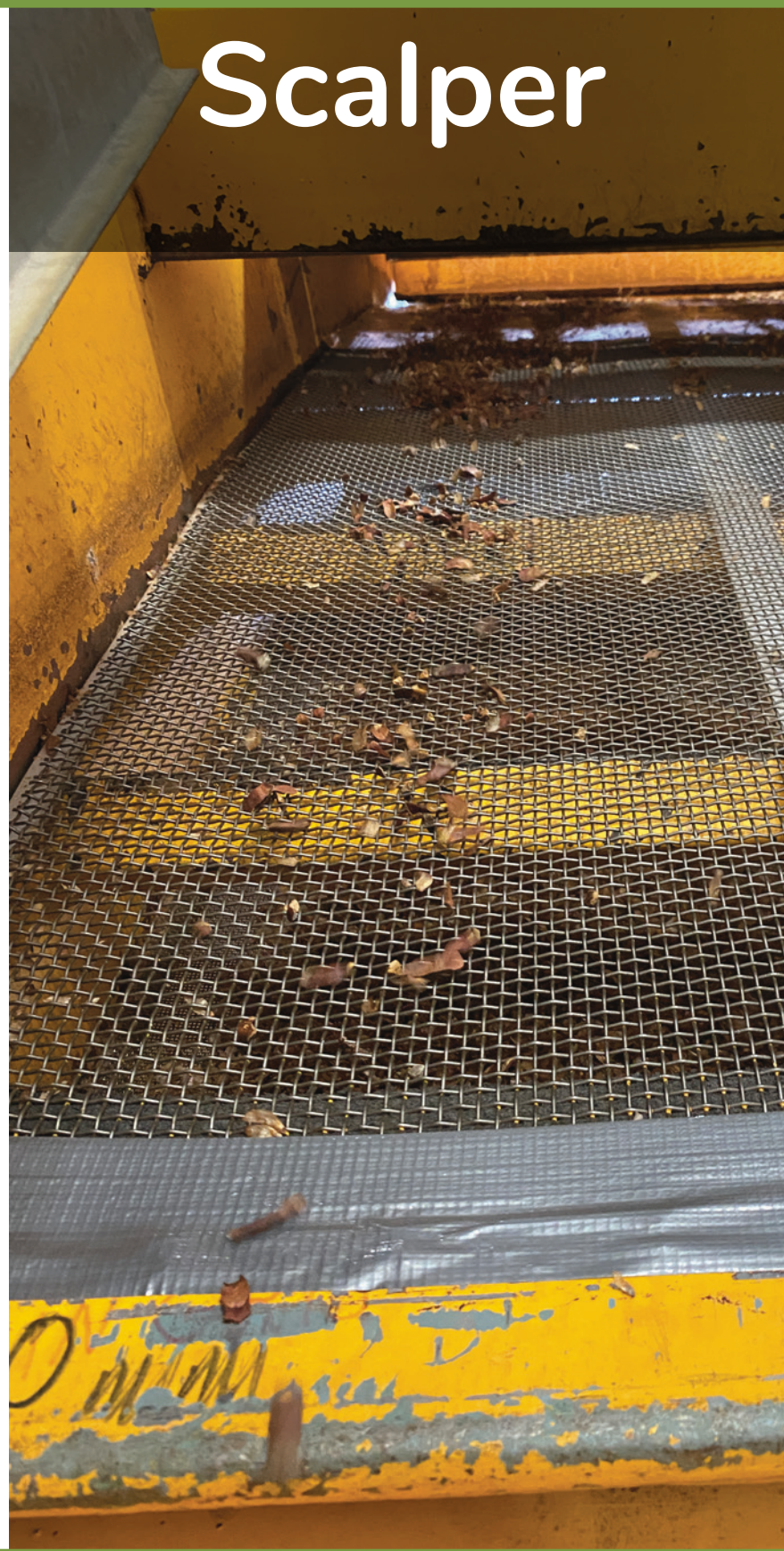
Résultat du 1 er nettoyage (graines avec ailes, débris d'aiguilles, résine)
