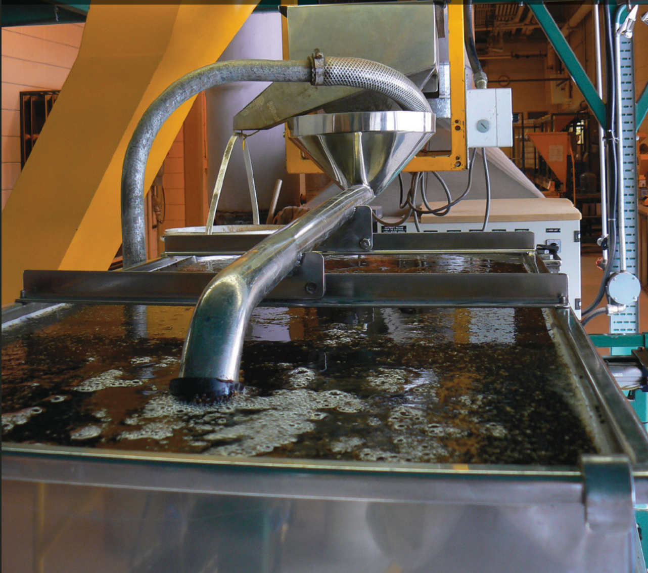
Immersion du lot dans le bassin d'eau (la résine cale et les graines flottent)
