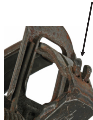
BASES DES MÂCHOIRES RENFORCÉES PAR SOUDURE
